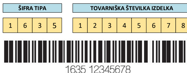
Slika 9: Zgradba črne kode GS1-128
